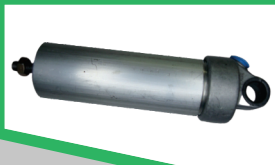
CILINDRO FREIO MOTOR SCANIA SÉRIE 5 Nº 1507790 Nº 4214113160
